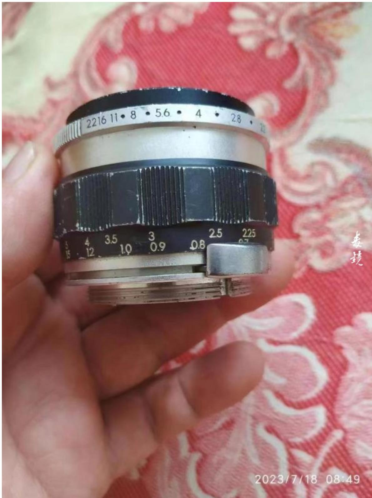
Takumar 1:2.2 f = 55mm是日本早期 Pentax级数单反相机的标准镜头之一。该镜头最大光圈f/2.2,提供了不错的低光拍摄能力。55mm等效焦距接近标准镜头,适合拍摄风光人像。
