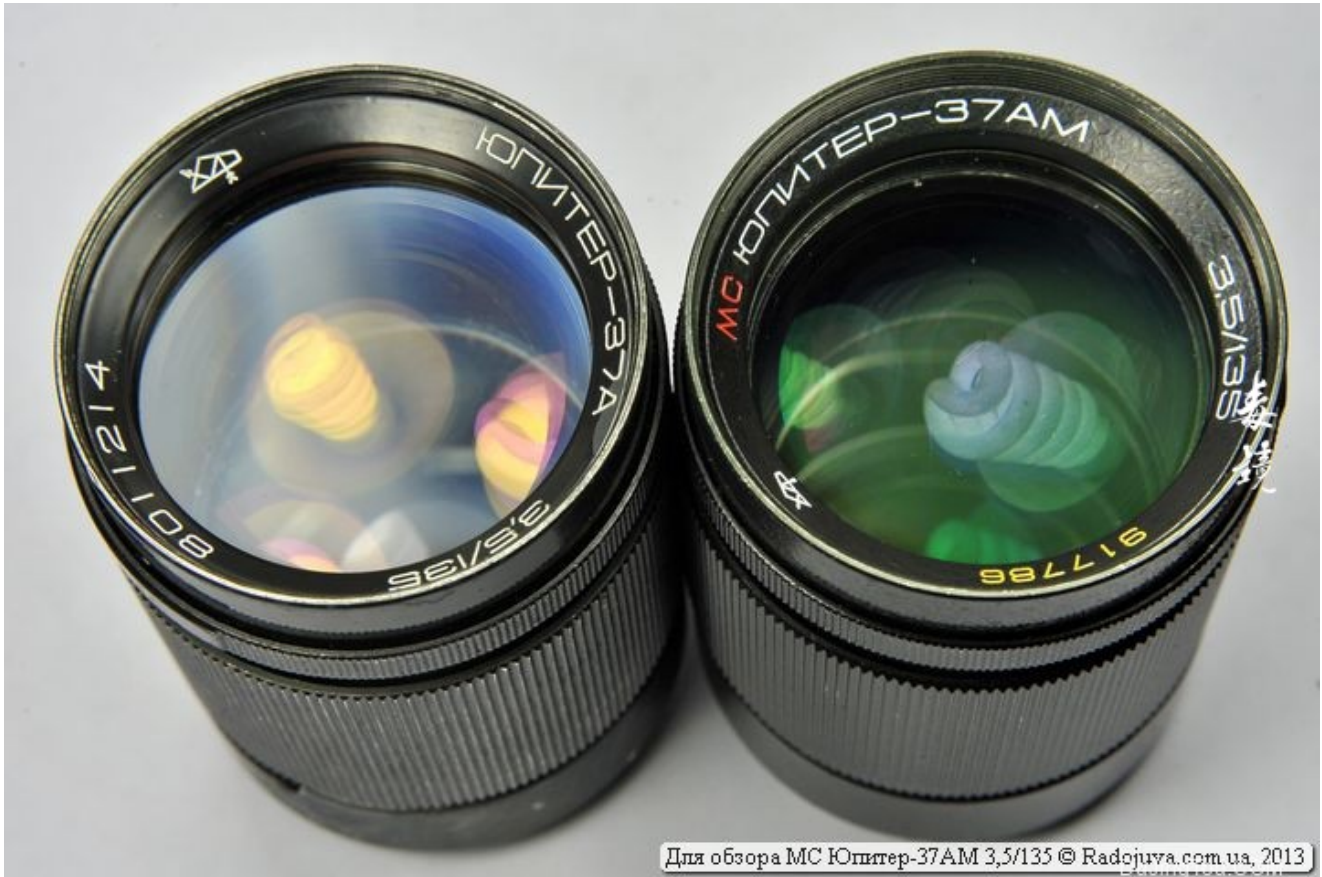
前置镜头Jupiter-37A 3,5 / 135和MS Jupiter-37AM 3,5 / 135的启蒙差异 照片和资料来自 博客作者 Radozhiva : Shapoval Arkady Arkadevich
