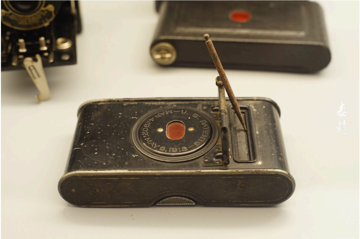
▲ Autographic金属触针（stylus）实物，收纳于机背小门凹槽中（毒镜头拍摄）
