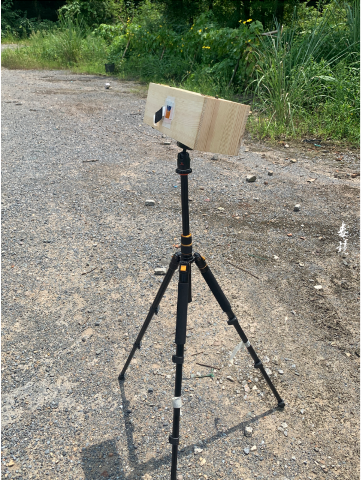
自制的使用工业探伤胶片的针孔相机
