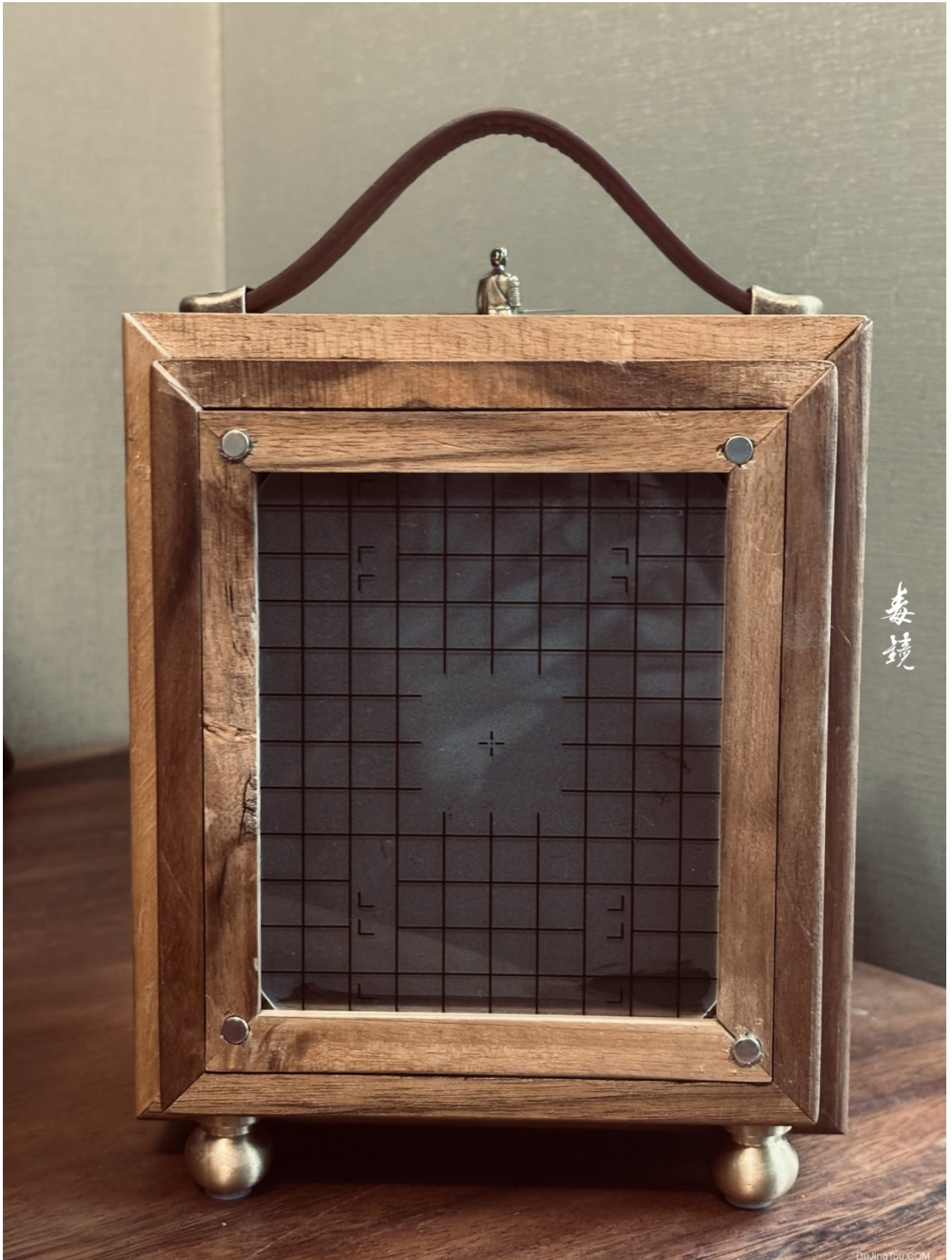
背面设计了对焦屏，可以抽出来，当采用镜头的时候可以进行对焦拍摄。
