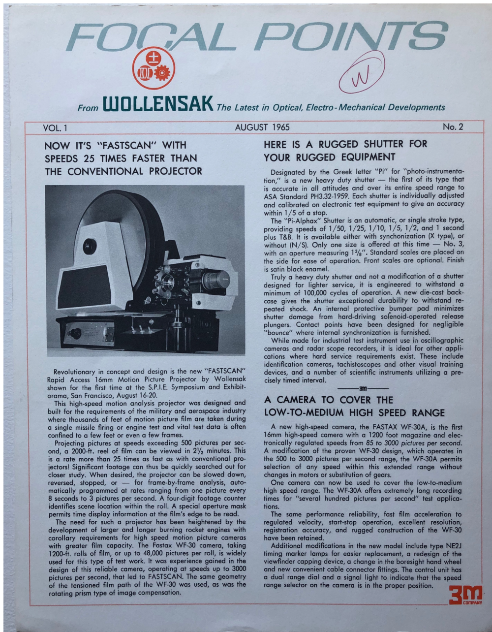
图7-3：1965年《Focal Points》Vol.1 No.2封面，介绍了为科学仪器与工业检测设计的Pi Alpha #3 重型快门。图片来源：Wollensak 百年资料库。
