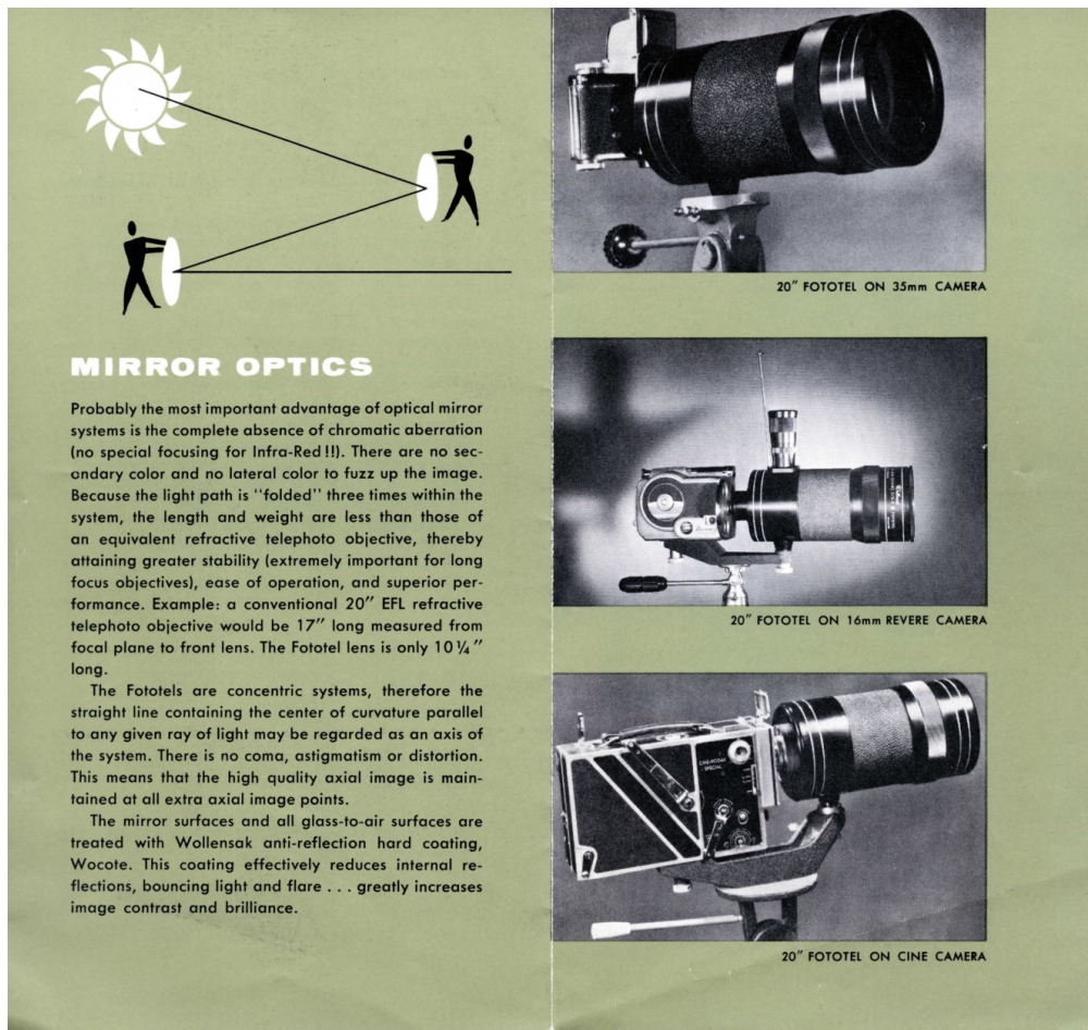
图5-5：1954年Fototel 20英寸f/6.3反射式长焦镜头技术手册页，展示了其在35mm相机、16mm Revere相机与电影摄影机上的安装方式。图片来源：Wollensak百年资料库。
