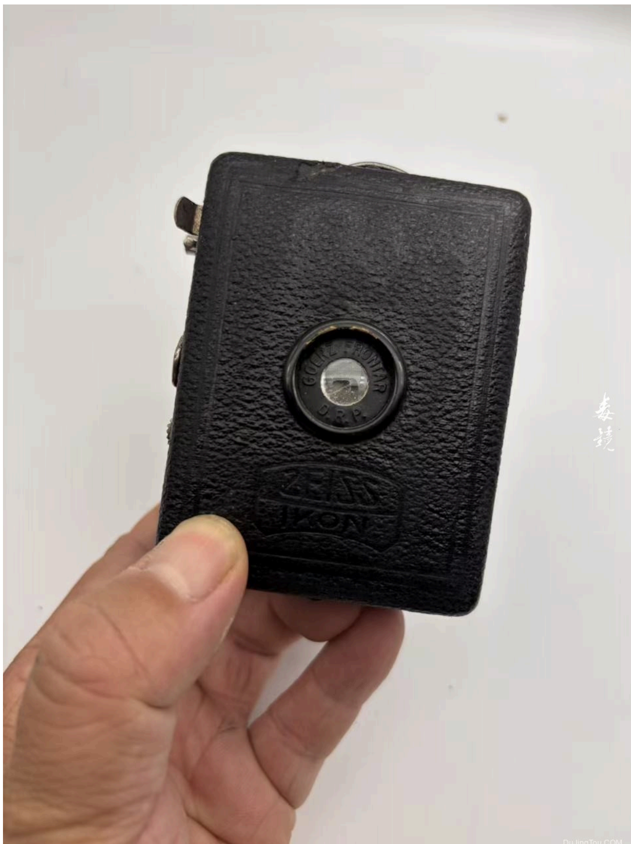
Baby Box Tengor正面整体外观，毒镜头摄。这台小巧的盒式相机将120画幅的Box Tengor缩小到127画幅，尺寸仅70×80×62毫米，可以轻松握在掌中。
