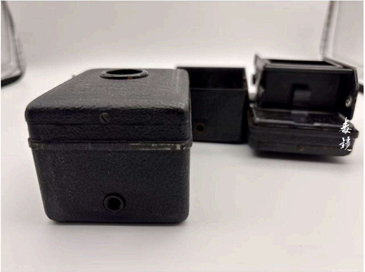
Baby Box Tengor底部的三脚架接口（横拍方向），毒镜头摄。侧面还有一个接口用于竖拍。
