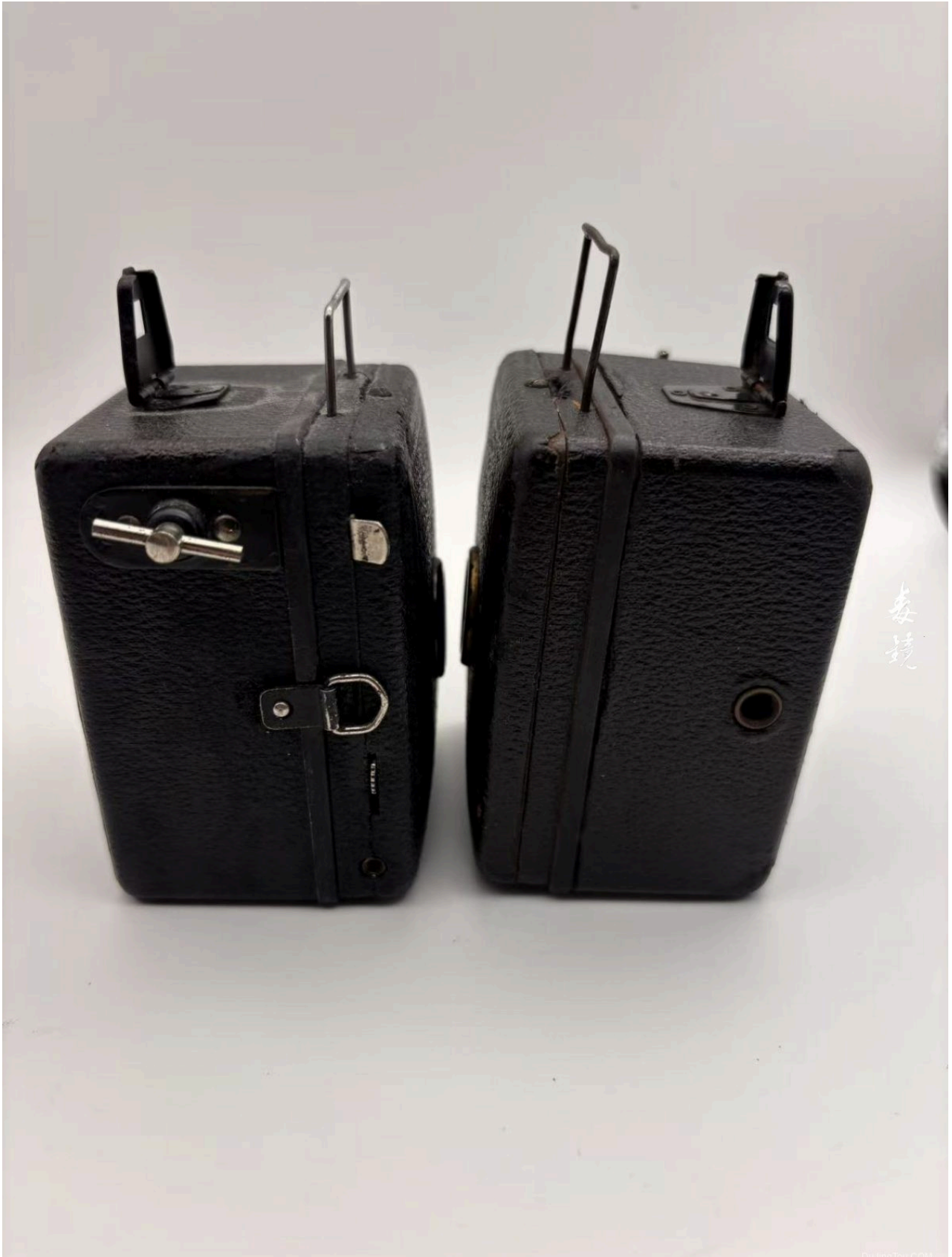
Baby Box Tengor线框取景器拉出状态，毒镜头摄。取景器由前方线框（F）和后方折叠瞄孔（G）组成。
