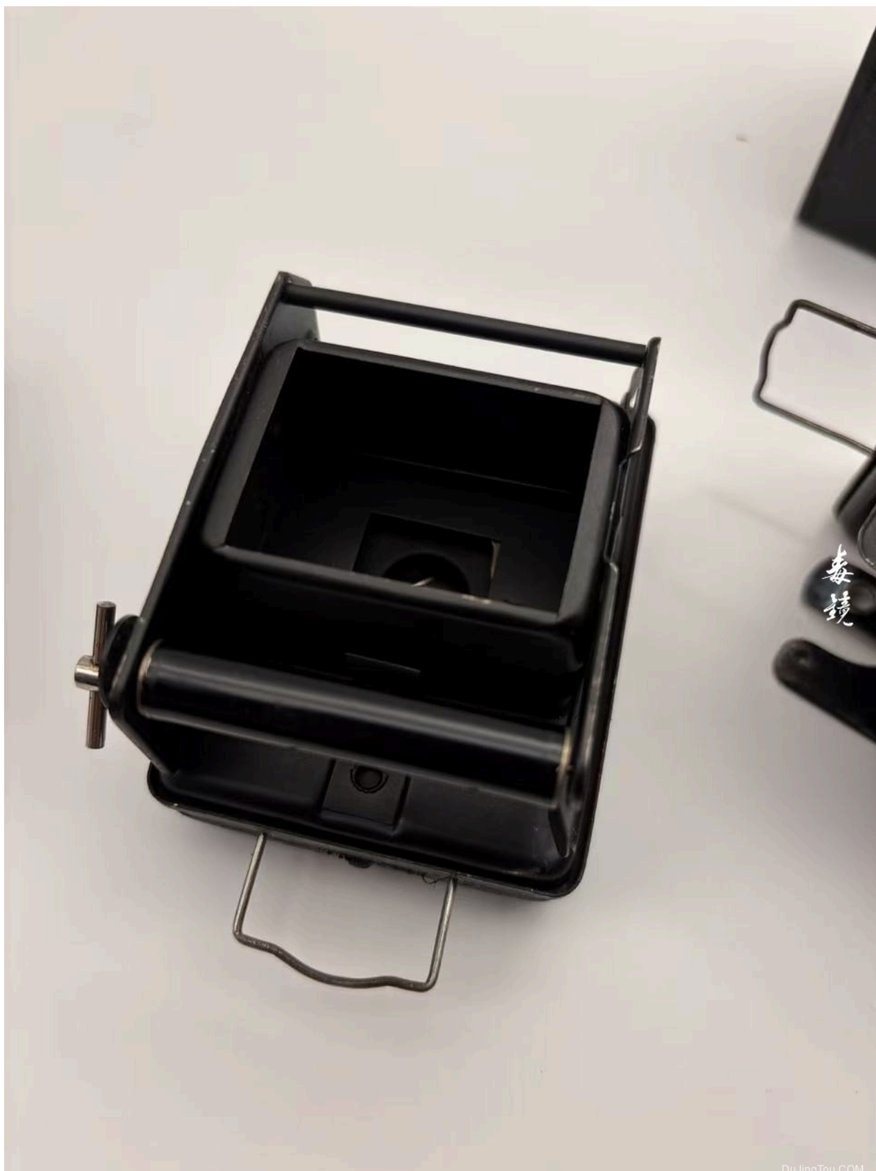
Baby Box Tengor前后半体分离状态，毒镜头摄。可见内部片仓结构、导纸辊和片轴架。
