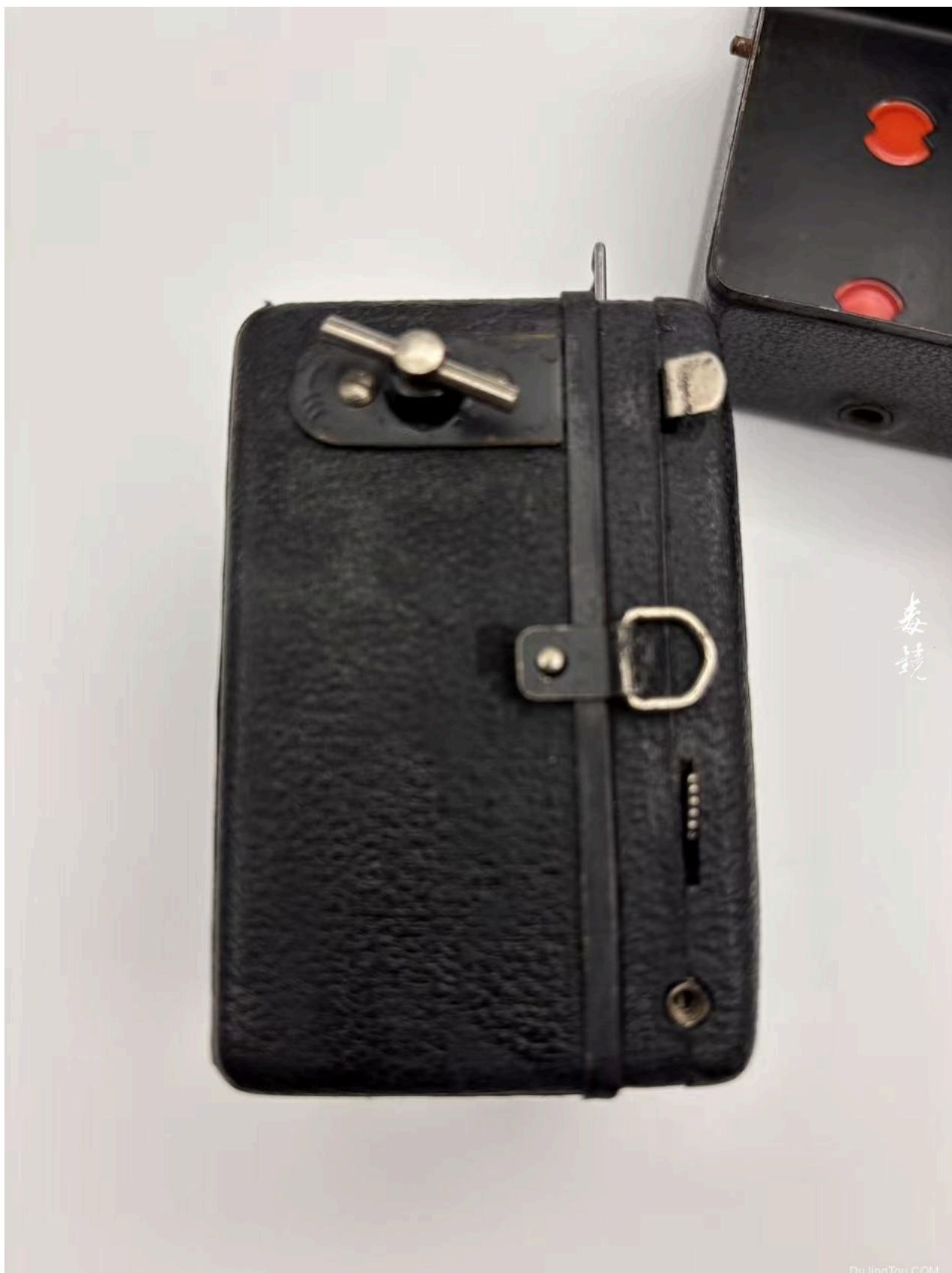
Baby Box Tengor右侧的T型卷片钥匙和快门释放杆，毒镜头摄。右侧可见卷片钥匙 (B)、I/T切换滑块 (C) 和快门释放杠杆 (D)。
